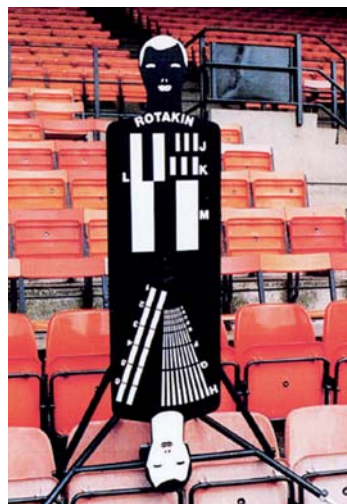
Der Rotakin-Test, der von der Home Office Police Scientific Development Branch (GB) entwickelt wurde, misst die Effizienz einer Überwachungskamera.
